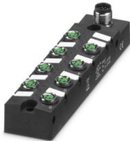
Caja distribuidora, aplicación: Estándar, tipo de conexión: Hembra M8 Metal, número de puestos enchufables: 8, número de polos: 3, codificación: A, ocupación de los puestos enchufables: simple, indicación de estado: sí, PNP; conexión de cable principal: Conexión enchufable M12 90°, apantallamiento: no
