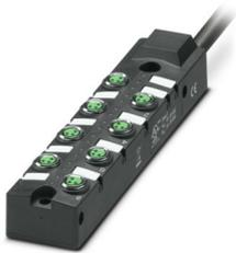
Caja distribuidora, aplicación: Estándar, tipo de conexión: Hembra M8 Metal, número de puestos enchufables: 8, número de polos: 3, codificación: A, ocupación de los puestos enchufables: simple, indicación de estado: sí, PNP; conexión de cable principal: Conexión fija 180°, PUR/PVC, longitud del cable: 5 m, apantallamiento: no
