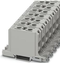
Borne de corriente, tensión nominal: 1000 V, corriente nominal: 145 A, número de conexiones: 2, número de polos: 1, tipo de conexión: Conexión por tornillo, Sección de dimensionamiento: 50 mm<sup>2</sup>, sección: 6 mm<sup>2</sup> - 50 mm<sup>2</sup>, Sección de dimensionamiento: 50 mm<sup>2</sup>, sección: 4 mm<sup>2</sup> - 50 mm<sup>2</sup>, clase de montaje: NS 35/15, NS 35/7,5, color: gris
