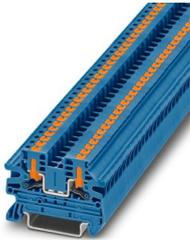
Borne de paso, tensión nominal: 800 V, corriente nominal: 24 A, número de conexiones: 2, número de polos: 1, tipo de conexión: Conexión push-in, Sección de dimensionamiento: 2,5 mm<sup>2</sup>, sección: 0,14 mm<sup>2</sup> - 4 mm<sup>2</sup>, clase de montaje: NS 35/7,5, NS 35/15, color: azul
