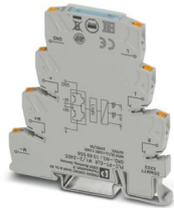
PLC-INTERFACE como relé electrónico de carga de inversión, compuesto de borna de base PLC-BPT.../21 con conexión push-in y circuito integrado, para controlar motores DC con indicador luminoso y circuito de protección, salida: 10 ... 30 V DC/2 A
