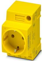
Toma de corriente, Cara enchufable tipo CF, tipo de conexión: Conexión por tornillo, color: amarillo, tensión nominal: 250 V AC (50 Hz), corriente nominal: 16 A, para el montaje sobre carril en la interfaz de servicio o montaje directo, normas/disposiciones: VDE 0620-1, Indicador de país: Alemania
