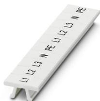
Tira de cinta Zack, Tiras, blanco, rotulado, longitudinal: L1, L2, L3, N, PE, L1, L2, L3, N, PE, clase de montaje: enclavar, para ancho de borne: 5,2 mm, Número de índices individuales: 10, altura del campo de texto: 10,5 mm, anchura del campo de texto: 5,15 mm
