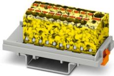
Bloque para distribución, Bloque con alineación vertical y alimentación integrada, tensión nominal: 500 V, corriente nominal: 17,5 A, número de conexiones: 19, tipo de conexión: Conexión push-in, Derivación, sección: 0,14 mm<sup>2</sup> - 2,5 mm<sup>2</sup>, Conexión colectiva, Sección de dimensionamiento: 4 mm<sup>2</sup>, sección: 0,2 mm<sup>2</sup> - 6 mm<sup>2</sup>, clase de montaje: NS 35/7,5, NS 35/15, color: negro/amarillo
