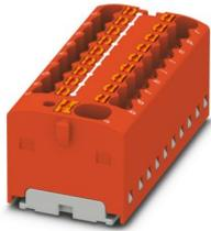
Bloque para distribución, Borne de base con alimentación, tensión nominal: 450 V, corriente nominal: 17,5 A, número de conexiones: 19, Derivación, sección: 0,14 mm<sup>2</sup> - 2,5 mm<sup>2</sup>, Conexión push-in, Conexión colectiva, Sección de dimensionamiento: 4 mm<sup>2</sup>, sección: 0,2 mm<sup>2</sup> - 6 mm<sup>2</sup>, clase de montaje: enclavar en adaptador para carril, Montaje directo con una brida, Aéreo, color: rojo
