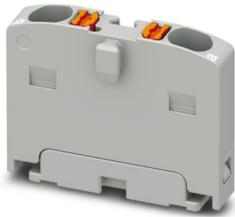
Monobloque, Borna de base, tensión nominal: 450 V, corriente nominal: 17,5 A, número de conexiones: 2, tipo de conexión: Conexión push-in, sección: 0,14 mm<sup>2</sup> - 2,5 mm<sup>2</sup>, clase de montaje: enclavar en adaptador para carril, Montaje directo con una brida, Aéreo, color: gris
