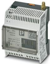
Relé SMS y módulo de indicación, versión para Europa, supervisión inalámbrica de valores digitales, conmutación remota de las salidas de relé, comunicación a través de SMS o conexión de datos inalámbrica (envío de correo electrónico, aplicaciones), tensión de alimentación 93 V ... 250 V AC
