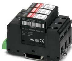
Dispositivo de protección contra sobretensiones para sistemas fotovoltaicos de tensión continua aislados y puestos a tierra de 1500 V DC y 2 polos, para montaje sobre carril DIN, elemento de base de 3 polos con contacto de indicación remota, tres elementos de protección enchufables con monitorización de temperatura, mensaje de estado en cada conector.
