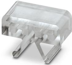
Soporte para señalización, Rotulación con tiras insertables de rotulación, incoloro, sin rotular, clase de montaje: enclavar, altura del campo de texto: 9,2 mm, anchura del campo de texto: 5,2 mm
