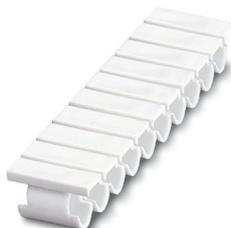
Manguito de identificación de conductores, Tiras, blanco, sin rotular, rotulable con: CMS-P1-PLOTTER, rango de diámetro de cable: 1,5 ... 3,2 mm, clase de montaje: deslizamiento, Número de índices individuales: 10, altura del campo de texto: 4,5 mm, anchura del campo de texto: 10 mm
