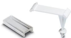
Soporte para marcado de módulos Phoenix, para señalización de módulos y placas de circuito impreso, para diámetro de taladro de 3,9 hasta 4,1 mm, grosor de pared o de placa 1,5 - 2,0 mm, rotulación con tiras de rotulación ESL, EST o ES/LP-BW-GB, superficie útil: 29 x 8 mm
