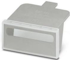
Soporte para señalización, Para el marcado de los grupos de bornas, para el soporte final E/UK o el terminal E/U, con tiras insertables de rotulación perforadas de 40 x 17 mm, gris, sin rotular, Perforado, clase de montaje: enclavar, altura del campo de texto: 17 mm, anchura del campo de texto: 40 mm
