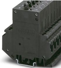
Interruptor de protección termomagnético, de 3 polos, semilento, 1 contacto abierto y 2 contactos cerrados, con pie universal para el montaje sobre NS 32 o NS 35
