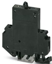
Interruptores de protección de aparatos magnetotérmico, 1-polos, tipo de conexión: Conexión por tornillo, corriente nominal: 0,6 A, curva característica de disparo: F1 (rápido), tipo de fusible: Fusible automático, clase de montaje: Carril simétrico: 35 mm, corriente asignada: 0,6 A
