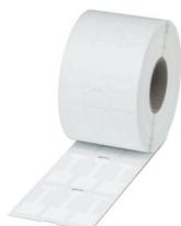
Banderita de marcado de cables, Rollo, blanco, sin rotular, rotulable con: THERMOMARK E.300 (D)/600 (D), THERMOMARK ROLL 2.0, THERMOMARK ROLL, THERMOMARK ROLL X1, THERMOMARK ROLLMaster 300/600, THERMOMARK X1.2, clase de montaje: pegado, diámetro de cable:  $\leq 6$  mm, Número de índices individuales: 2500, altura del campo de texto: 10 mm, anchura del campo de texto: 20 mm
