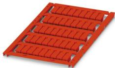
Manguito de identificación de conductores, Estera, rojo, sin rotular, rotulable con: BLUEMARK E. CARD, BLUEMARK ID COLOR, BLUEMARK ID, BLUEMARK CLED, THERMOMARK PRIME 2.0, THERMOMARK PRIME, THERMOMARK CARD 2.0, THERMOMARK CARD, TOPMARK NEO, TOPMARK LASER, rango de diámetro de cable: 2,5 ... 4,7 mm, clase de montaje: deslizamiento, para ancho de borne: 5,2 mm, Número de índices individuales: 45, altura del campo de texto: 5,5 mm, anchura del campo de texto: 12 mm
