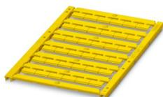
Marcador para bornes, Estera, amarillo, sin rotular, rotulable con: BLUEMARK E.CARD, BLUEMARK ID COLOR, BLUEMARK ID, BLUEMARK CLED, THERMOMARK PRIME 2.0, THERMOMARK PRIME, THERMOMARK CARD 2.0, THERMOMARK CARD, TOPMARK NEO, TOPMARK LASER, clase de montaje: enclavar, para ancho de borne: 10,2 mm, Número de índices individuales: 36, altura del campo de texto: 4,7 mm, anchura del campo de texto: 9,4 mm
