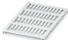
Marcador de conductores, Estera, blanco, sin rotular, rotulable con: BLUEMARK E.CARD, BLUEMARK ID COLOR, BLUEMARK ID, BLUEMARK CLED, PLOTMARK, CMS-P1-PLOTTER, rango de diámetro de cable: 1,3 ... 1,6 mm, clase de montaje: deslizamiento, Número de índices individuales: 40, altura del campo de texto: 3 mm, anchura del campo de texto: 12 mm
