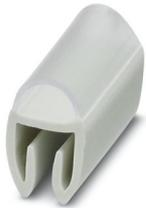
Soporte para señalización de conductores, transparente, sin rotular, rango de diámetro de cable: 2 ... 3,5 mm, clase de montaje: enganchar, altura del campo de texto: 4 mm, anchura del campo de texto: 12 mm
