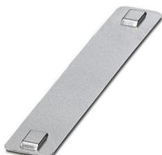
Soporte para manguito de identificación de conductores, plateado, sin rotular, clase de montaje: Montaje con sujetacables, diámetro de cable: > 16 mm, altura del campo de texto: 10 mm, anchura del campo de texto: 47 mm
