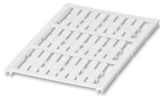
Marcador de conductores, Estera, blanco, sin rotular, rotulable con: BLUEMARK E.CARD, BLUEMARK ID COLOR, BLUEMARK ID, BLUEMARK CLED, PLOTMARK, CMS-P1-PLOTTER, rango de diámetro de cable: 1,9 ... 3,1 mm, clase de montaje: enganchar, Número de índices individuales: 12, altura del campo de texto: 4 mm, anchura del campo de texto: 30 mm
