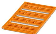
Marcador para bornes, Estera, naranja, sin rotular, rotulable con: BLUEMARK E.CARD, BLUEMARK ID COLOR, BLUEMARK ID, BLUEMARK CLED, PLOTMARK, CMS-P1-PLOTTER, clase de montaje: enclavar, para ancho de borne: 5,2 mm, Número de índices individuales: 96, altura del campo de texto: 5,1 mm, anchura del campo de texto: 4,6 mm
