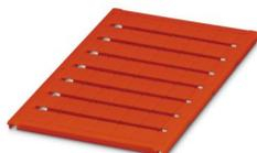
Marcador para bornes, Estera, rojo, sin rotular, rotulable con: BLUEMARK E.CARD, BLUEMARK ID COLOR, BLUEMARK ID, BLUEMARK CLED, PLOTMARK, CMS-P1-PLOTTER, clase de montaje: enclavar, para ancho de borne: 10,2 mm, Número de índices individuales: 48, altura del campo de texto: 10,5 mm, anchura del campo de texto: 9,6 mm
