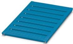
Marcador para bornes, Estera, azul, sin rotular, rotulable con: BLUEMARK E.CARD, BLUEMARK ID COLOR, BLUEMARK ID, BLUEMARK CLED, PLOTMARK, CMS-P1-PLOTTER, clase de montaje: enclavar, para ancho de borne: 5,2 mm, Número de índices individuales: 96, altura del campo de texto: 10,5 mm, anchura del campo de texto: 4,6 mm
