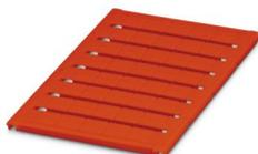
Marcador para bornes, Estera, rojo, sin rotular, rotulable con: BLUEMARK E.CARD, BLUEMARK ID COLOR, BLUEMARK ID, BLUEMARK CLED, PLOTMARK, CMS-P1-PLOTTER, clase de montaje: enclavar, para ancho de borne: 12 mm, Número de índices individuales: 40, altura del campo de texto: 10,5 mm, anchura del campo de texto: 11,45 mm
