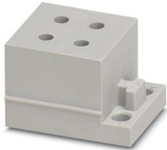
Pasacables, pequeña, número de conductores: 4, tipo: Cable redondo, hendido, diámetro exterior del cable: 4x 2 mm ... 3 mm, material: SEBS (sin halógenos), color: gris, longitud: 29,5 mm, anchura: 19,5 mm, altura: 17 mm
