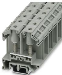
Borne universal con conexión por espárrago, tornillo de cabeza ranurada, sección: 1 mm<sup>2</sup> ... 25 mm<sup>2</sup>, ancho: 18 mm, color: gris
