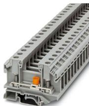
Borna seccionable, con patín deslizante, tensión nominal: 1000 V, corriente nominal: 36 A, tipo de conexión: Conexión por espárrago, Sección de dimensionamiento: 6 mm<sup>2</sup>, montaje: NS 35/7,5, NS 35/15, NS 32, color: gris
