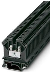
Borne de paso, tensión nominal: 800 V, corriente nominal: 24 A, número de conexiones: 2, tipo de conexión: Conexión por tornillo, Sección de dimensionamiento: 2,5 mm<sup>2</sup>, sección: 0,2 mm<sup>2</sup> - 4 mm<sup>2</sup>, clase de montaje: NS 35/7,5, NS 35/15, NS 32, color: negro
