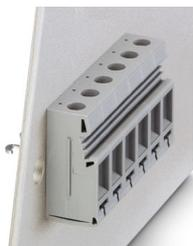
Borne de paso, tipo de conexión: Conexión por tornillo con cápsula de tracción, Conexión por soldadura, número de polos: 1, corriente de carga: 41 A, sección: 0,2 mm<sup>2</sup> - 10 mm<sup>2</sup>, dirección de conexión del conductor con respecto a la dirección de enchufe: 0 °, anchura: 10 mm, color: gris
