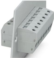
Borne de paso, tipo de conexión: Conexión por tornillo con cápsula de tracción, Conexión por tornillo con cápsula de tracción, número de polos: 1, corriente de carga: 76 A, sección: 0,5 mm<sup>2</sup> - 25 mm<sup>2</sup>, dirección de conexión del conductor con respecto a la dirección de enchufe: 0 °, anchura: 12 mm, color: verde-amarillo
