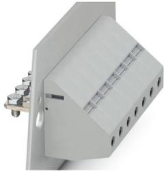
Borne de paso, tipo de conexión: Conexión por tornillo con cápsula de tracción, Conexión por terminal, número de polos: 1, corriente de carga: 101 A, sección: 6 mm<sup>2</sup> - 35 mm<sup>2</sup>, dirección de conexión del conductor con respecto a la dirección de enchufe: -90 °, anchura: 15,1 mm
