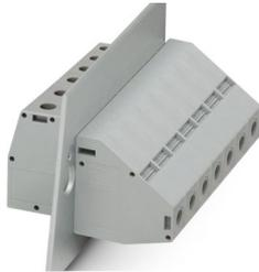
Borne de paso, tipo de conexión: Conexión por tornillo con cápsula de tracción, Conexión por tornillo con cápsula de tracción, número de polos: 1, corriente de carga: 150 A, sección: 16 mm<sup>2</sup> - 50 mm<sup>2</sup>, dirección de conexión del conductor con respecto a la dirección de enchufe: -90 °, anchura: 18,8 mm
