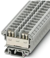
Borne de paso, tensión nominal: 800 V, corriente nominal: 76 A, número de conexiones: 2, tipo de conexión: Conexión por tornillo, 1er piso, sección: 0,5 mm<sup>2</sup> - 16 mm<sup>2</sup>, clase de montaje: NS 35/7,5, NS 35/15, NS 32, color: gris
