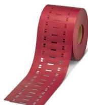
Kabelmarker, bestellbar: zeilenweise, rot, beschriftet nach Kundenangaben, Montageart: Kabelbindermontage, Kabeldurchmesser:  $\geq 6$  mm, Textfeldhöhe: 12 mm, Textfeldbreite: 40 mm
