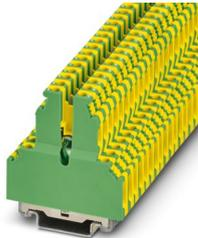
Schutzleiter-Reihenklemme, Anzahl der Anschlüsse: 4, Anschlussart: Schraubanschluss, 1. und 2. Etage, Querschnitt: 0,2 mm<sup>2</sup> - 4 mm<sup>2</sup>, Montageart: NS 35/7,5, NS 35/15, Farbe: grün-gelb
