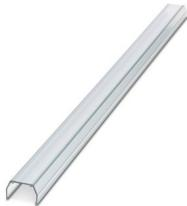
Abdeckprofil, zum Abdecken von Klemmenleisten, wird auf Abdeckprofilträger AP 2-TU gerastert, beschriftbar mit Einsteckstreifen AP-ES. An den Enden und in Abständen von ca. 40 cm ist ein Abdeckprofilträger zu setzen. Lieferlänge: 1 m
