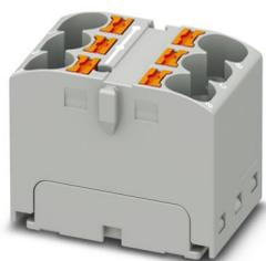
Verteilerblock, Grundklemme, Nennspannung: 450 V, Nennstrom: 32 A, Anzahl der Anschlüsse: 6, Anschlussart: Push-in-Anschluss, Querschnitt: 0,2 mm<sup>2</sup> - 6 mm<sup>2</sup>, Montageart: kleben, Farbe: grau
