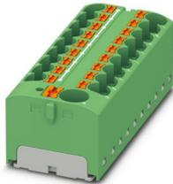
Verteilerblock, Nennspannung: 450 V, Nennstrom: 32 A, Anzahl der Anschlüsse: 19, Anschlussart: Push-in-Anschluss, Bemessungsquerschnitt: 4 mm<sup>2</sup>, Abgriff, Querschnitt: 0,2 mm<sup>2</sup> - 6 mm<sup>2</sup>, Push-in-Anschluss, Sammelschluss, Bemessungsquerschnitt: 10 mm<sup>2</sup>, Querschnitt: 0,5 mm<sup>2</sup> - 10 mm<sup>2</sup>, Montageart: aufrasten auf Tragschienenadapter, Direktmontage mit Flansch, Fliegend, Farbe: grün
