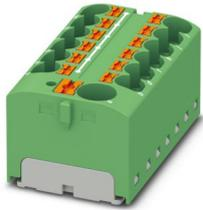
Verteilerblock, Nennspannung: 450 V, Nennstrom: 32 A, Anzahl der Anschlüsse: 13, Anschlussart: Push-in-Anschluss, Bemessungsquerschnitt: 4 mm<sup>2</sup>, Abgriff, Querschnitt: 0,2 mm<sup>2</sup> - 6 mm<sup>2</sup>, Push-in-Anschluss, Sammelanschluss, Bemessungsquerschnitt: 10 mm<sup>2</sup>, Querschnitt: 0,5 mm<sup>2</sup> - 10 mm<sup>2</sup>, Montageart: aufrasten auf Tragschienenadapter, Direktmontage mit Flansch, Fliegend, Farbe: grün
