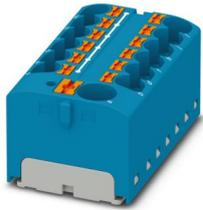
Verteilerblock, Nennspannung: 450 V, Nennstrom: 32 A, Anzahl der Anschlüsse: 13, Anschlussart: Push-in-Anschluss, Bemessungsquerschnitt: 4 mm<sup>2</sup>, Abgriff, Querschnitt: 0,2 mm<sup>2</sup> - 6 mm<sup>2</sup>, Push-in-Anschluss, Sammelanschluss, Bemessungsquerschnitt: 10 mm<sup>2</sup>, Querschnitt: 0,5 mm<sup>2</sup> - 10 mm<sup>2</sup>, Montageart: aufrasten auf Tragschienenadapter, Direktmontage mit Flansch, Fliegend, Farbe: blau
