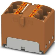
Verteilerblock, intern gebrückt, Nennspannung: 450 V, Nennstrom: 32 A, Anzahl der Anschlüsse: 6, Anschlussart: Push-in-Anschluss, Querschnitt: 0,2 mm<sup>2</sup> - 6 mm<sup>2</sup>, Montageart: aufrasten auf Tragschienenadapter, Direktmontage mit Flansch, Fliegend, Farbe: braun
