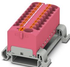
Verteilerblock, Nennspannung: 800 V, Nennstrom: 32 A, Anzahl der Anschlüsse: 19, Anschlussart: Push-in-Anschluss, Bemessungsquerschnitt: 4 mm<sup>2</sup>, Abgriff, Querschnitt: 0,2 mm<sup>2</sup> - 6 mm<sup>2</sup>, Push-in-Anschluss, Sammelanschluss, Bemessungsquerschnitt: 10 mm<sup>2</sup>, Querschnitt: 0,5 mm<sup>2</sup> - 10 mm<sup>2</sup>, Montageart: NS 35/7,5, NS 35/15, Farbe: pink
