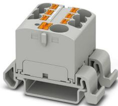
Verteilerblock, Block mit waagerechter Ausrichtung und integrierter Einspeisung, Nennspannung: 800 V, Nennstrom: 32 A, Anzahl der Anschlüsse: 7, Anschlussart: Push-in-Anschluss, Bemessungsquerschnitt: 4 mm<sup>2</sup>, Abgriff, Querschnitt: 0,2 mm<sup>2</sup> - 6 mm<sup>2</sup>, Push-in-Anschluss, Sammelschluss, Bemessungsquerschnitt: 10 mm<sup>2</sup>, Querschnitt: 0,5 mm<sup>2</sup> - 10 mm<sup>2</sup>, Montageart: NS 35/7,5, NS 35/15, Farbe: grau
