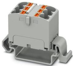
Verteilerblock, Block mit waagerechter Ausrichtung, Nennspannung: 800 V, Nennstrom: 32 A, Anzahl der Anschlüsse: 6, Anschlussart: Push-in-Anschluss, Querschnitt: 0,2 mm<sup>2</sup> - 6 mm<sup>2</sup>, Montageart: NS 35/7,5, NS 35/15, Farbe: grau
