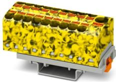
Verteilerblock, Nennspannung: 800 V, Nennstrom: 32 A, Anzahl der Anschlüsse: 19, Anschlussart: Push-in-Anschluss, Bemessungsquerschnitt: 4 mm<sup>2</sup>, Abgriff, Querschnitt: 0,2 mm<sup>2</sup> - 6 mm<sup>2</sup>, Push-in-Anschluss, Sammelanschluss, Bemessungsquerschnitt: 10 mm<sup>2</sup>, Querschnitt: 0,5 mm<sup>2</sup> - 10 mm<sup>2</sup>, Montageart: NS 35/7,5, NS 35/15, Farbe: schwarz/gelb
